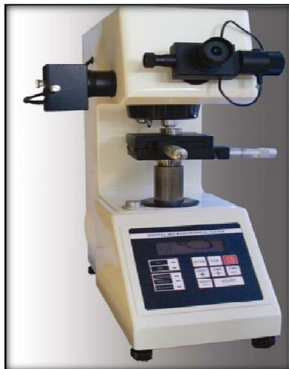
Fig.III.12. Microduromètre de type AFFRI 1–21056 INDULODONA.
