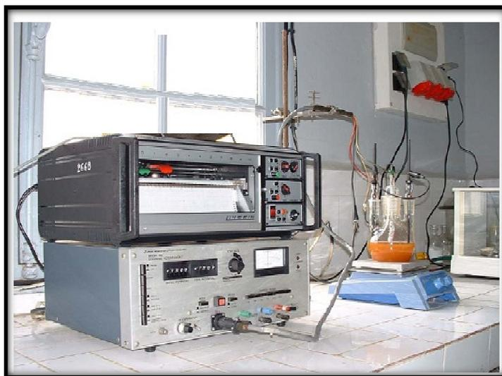
Fig.III.8. Installation de mesure des courbes de polarisation potentiostatiques.
