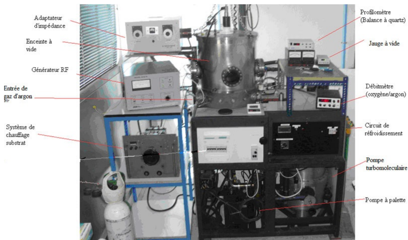
FIGURE 3.4 – Dispositif expérimental du pulvérisateur cathodique.
