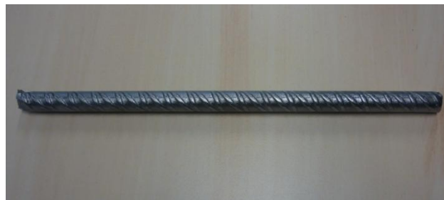
Figure III. 3 Barre d'armature après brossage métallique
