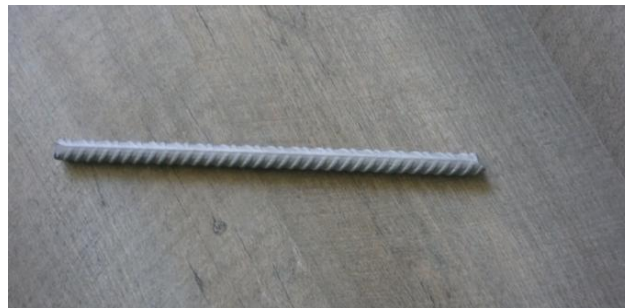
Figure III.2 Barre d'armature après sablage
