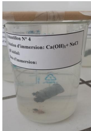
Figure III. 12 Echantillon immergé dans la solution à 3.5% NaCl, après corrosion
