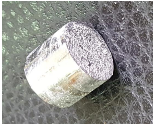
Figure II.13 Echantillon en acier doux après 21 jours d'immersion dans la solution CPS2.
