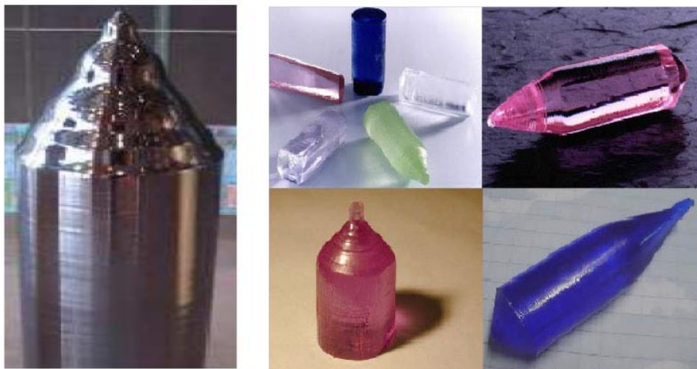
Figure I.1: Exemples de monocristaux massifs obtenus par tirage Czochralski [9]
