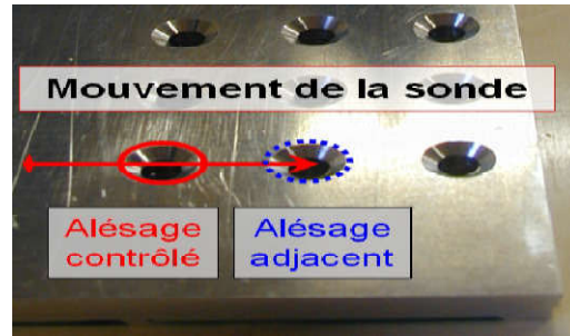
Fig. IV. 16 Photo alésage de rivet adjacents, (Paillard, 2008).
