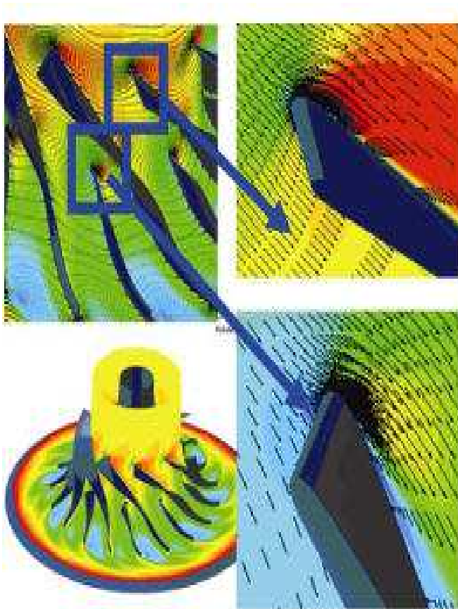
Fig. 1.14 : Contours du nombre de Mach relatif et vecteurs de la vitesse relative, XinQian Zheng (2010)
