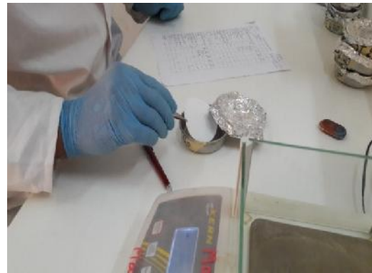
Figure 3.8(f) Pesée avec papier filtre
