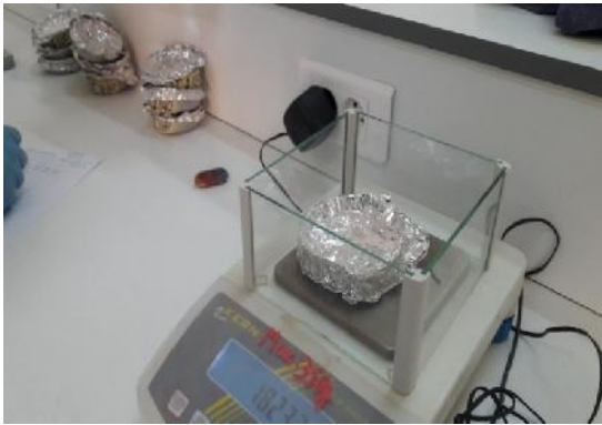
Figure 3.8(e) Pesée de la tare
