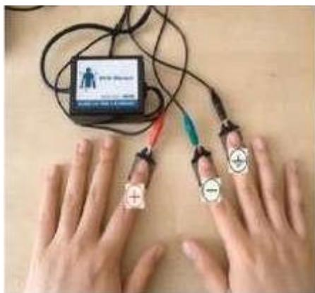
**Figure 1.10:** Aperçu de l'interface du système d'identification HeartID. Lorsque l'utilisateur place ses doigts sur les capteurs de rythme cardiaque, un algorithme de reconnaissance traite le signal et le compare avec l'électrocardiogramme de la personne préalablement enregistré.
