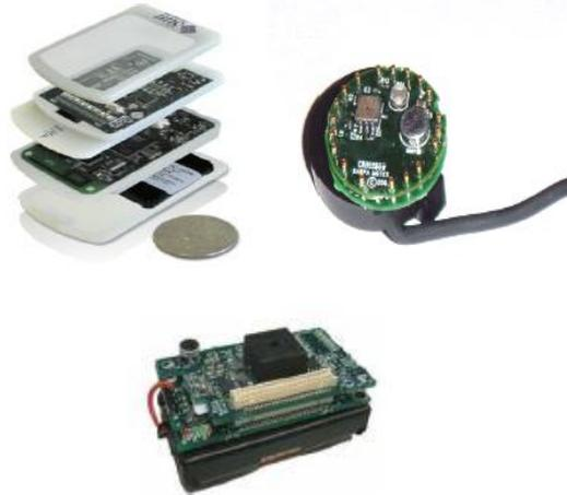
**Figure 1.2** Exemple d'un nœud capteur.
