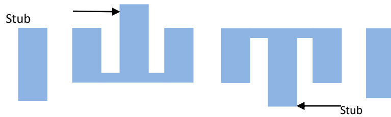
Figure 1. 16. Filtre à Stub
