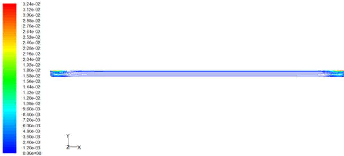
Figure.III.27.b. Contours de vitesses pour d_1 = 0,0029 m et \text{grad}_x T = 19 K.
