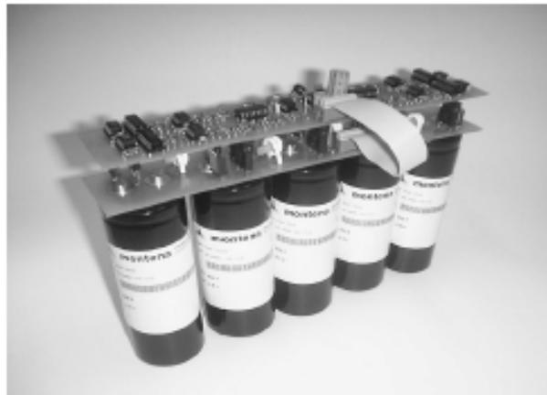
Fig. I.2 Connexion des supercondensateurs
