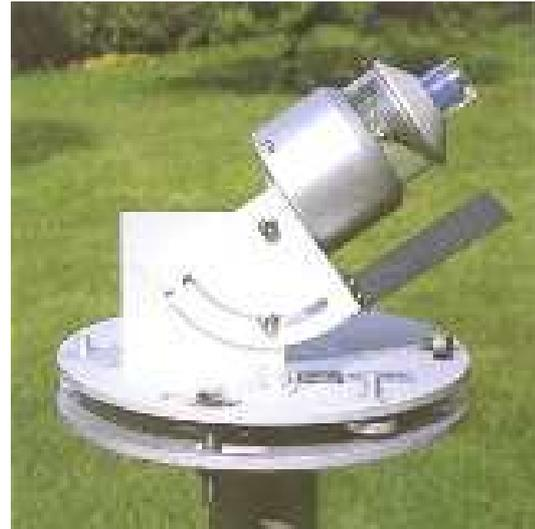
figure (III-3-2): Héliographe à fibres optique[17].
