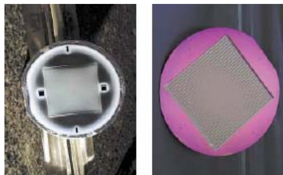
Figure I.4. Couche fragilisée par anodisation (a), détachée et collée diamètre = 2 pouces, épaisseur = 40 \mu m (b) et fragilisée par implantation ionique (c).
