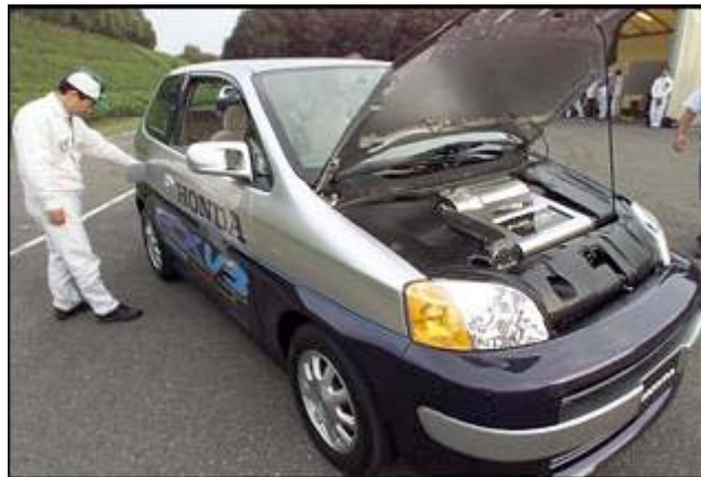
Prototype Honda FCX-V3 équipé d'un réservoir d'hydrogène sous pression.
