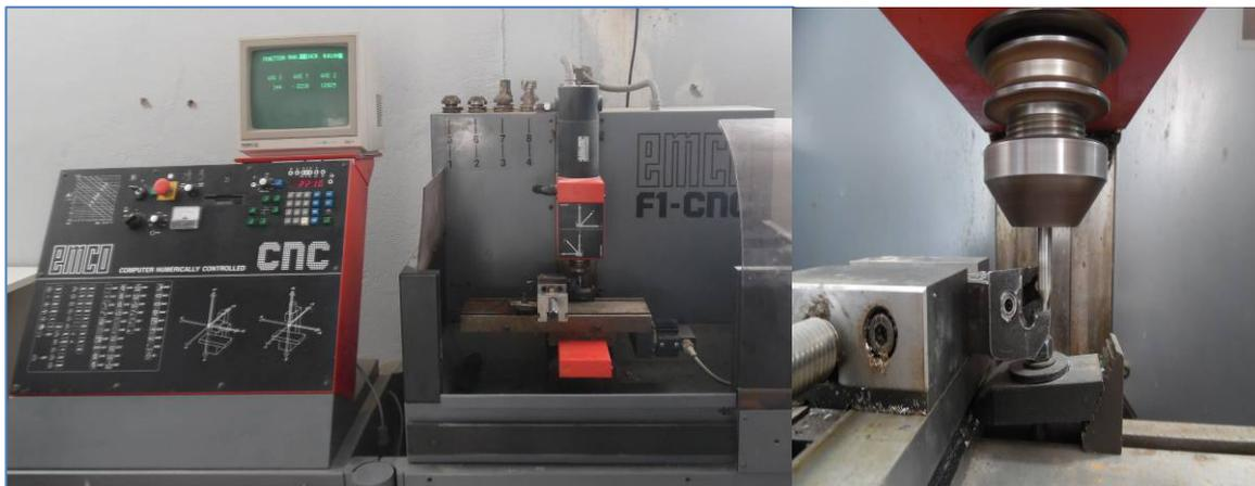
Figure II. 9: Fraiseuse CNC utilisée lors du perçage de porte plaquette
