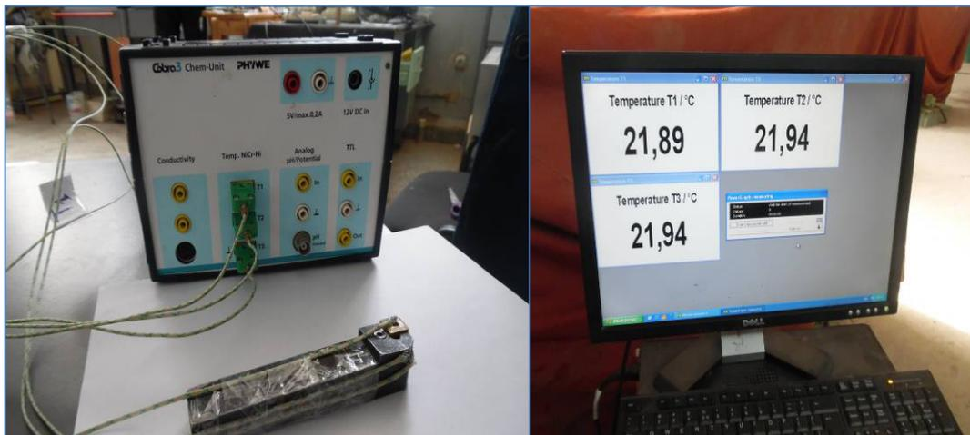
Figure II.11: Montage des thermocouples.
