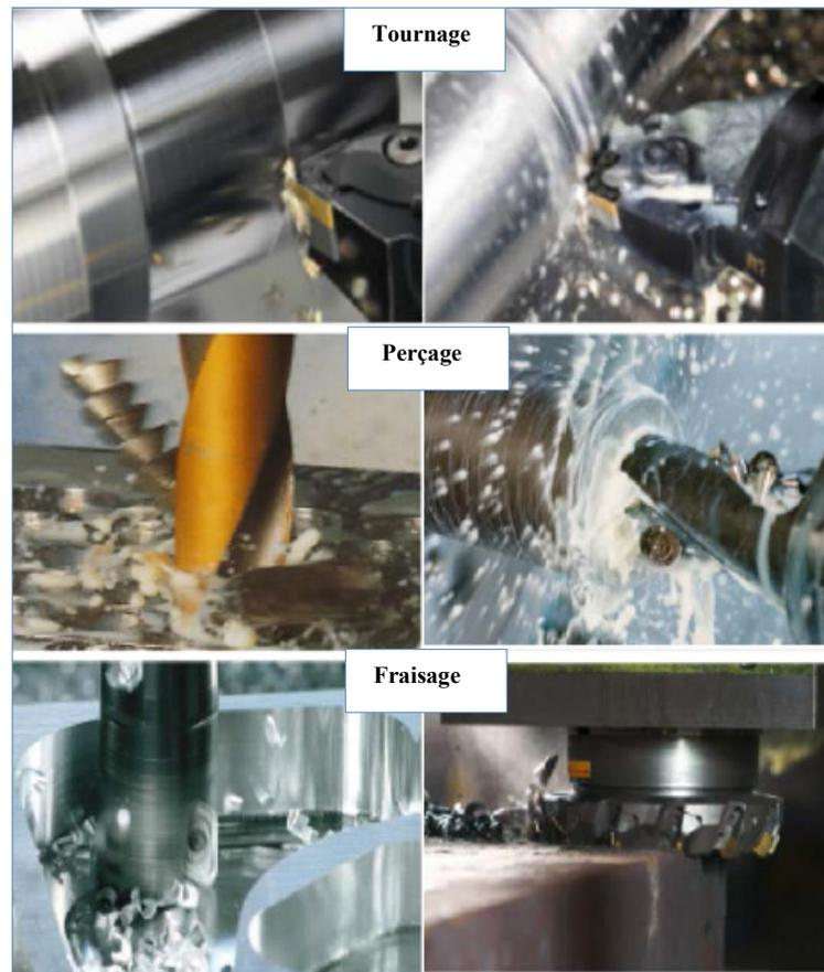
Figure I.1: Exemples des procédés d'usinage par enlèvement de matière [2].
