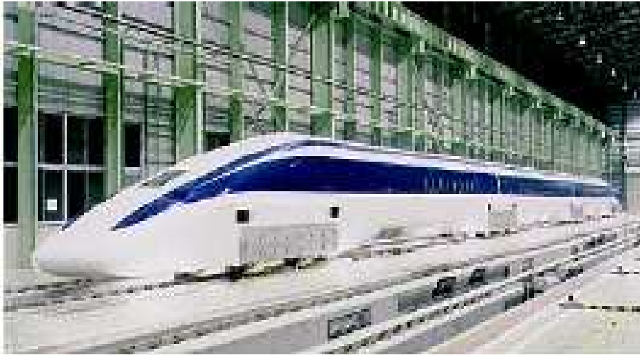
Figure (I.23) : Train à grande vitesse TGV japonais, à voie active, à vitesse de 500 km/h.
