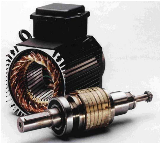
Fig. 1.2. Le moteur industriel à aimants permanents de quelques kW
