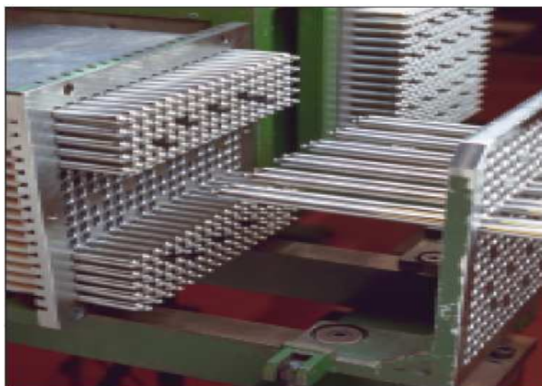
Figure 1.7 : Les crayons de combustible renferment de l'oxyde d'uranium, [15].
