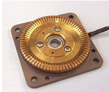
Figure 2.16- Le stator du moteur SHINSEI USR60 [8].
