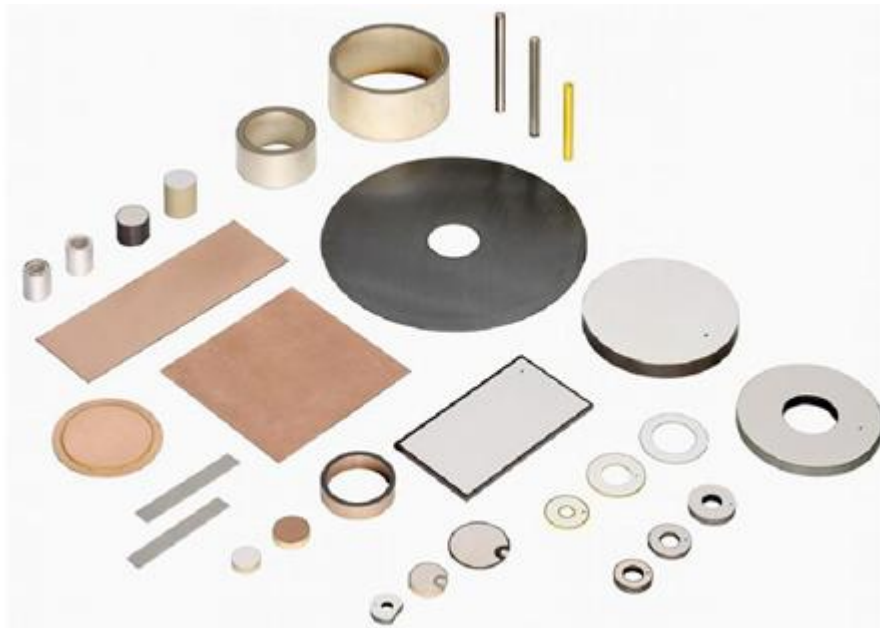
Figure 1.5 -Différentes formes de céramiques piézoélectriques [41].
