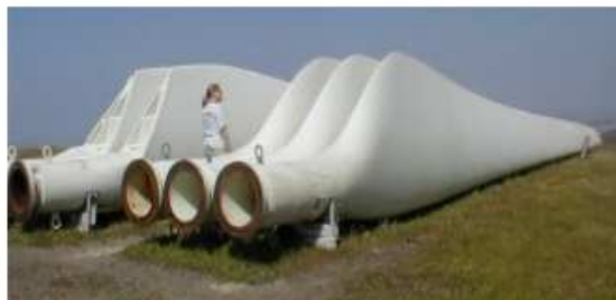
Fig. 2.16 Pales de remplacement mesurant environ 15 m de long
