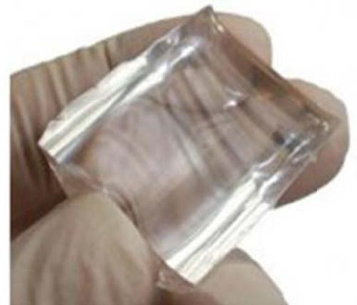
En dehors de la microfluidique il est utilisé comme additif alimentaire (E900), dans les shampoings, comme anti-moussant dans les boissons ou dans les huiles lubrifiantes. Pour la fabrication de dispositif microfluidiques, le PDMS (liquide) mélangé à un agent réticulant est versé sur un moule microstructuré et chauffé afin d'obtenir une réplique du moule en élastomère (PDMS réticulé) [7].
