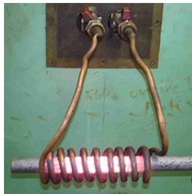
Fig. 3 Chauffage par induction par une solénoïde
