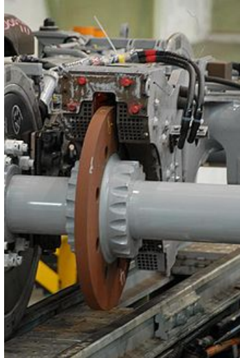
Fig.2 Frein à courants de Foucault sur un train rapide japonais Shinkansen.
