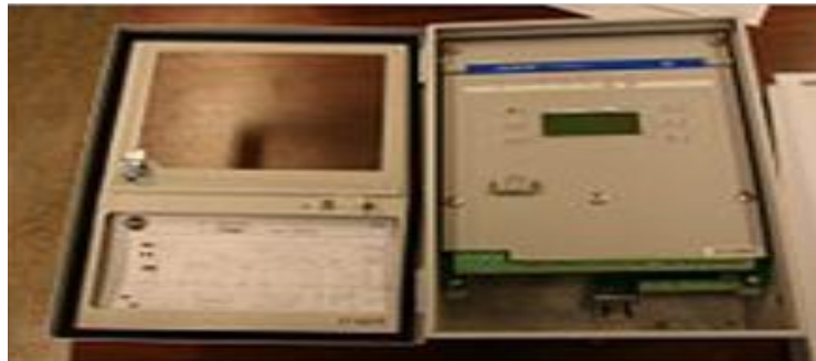
Fig.I.14. Un relais de réglage automatique de transformateurs.
