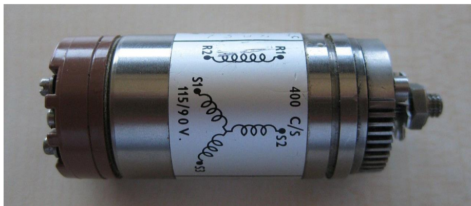
Figure (I.16) : SELSYN selon l'affectation des bornes (ici pour l'opération de 400 Hz).
