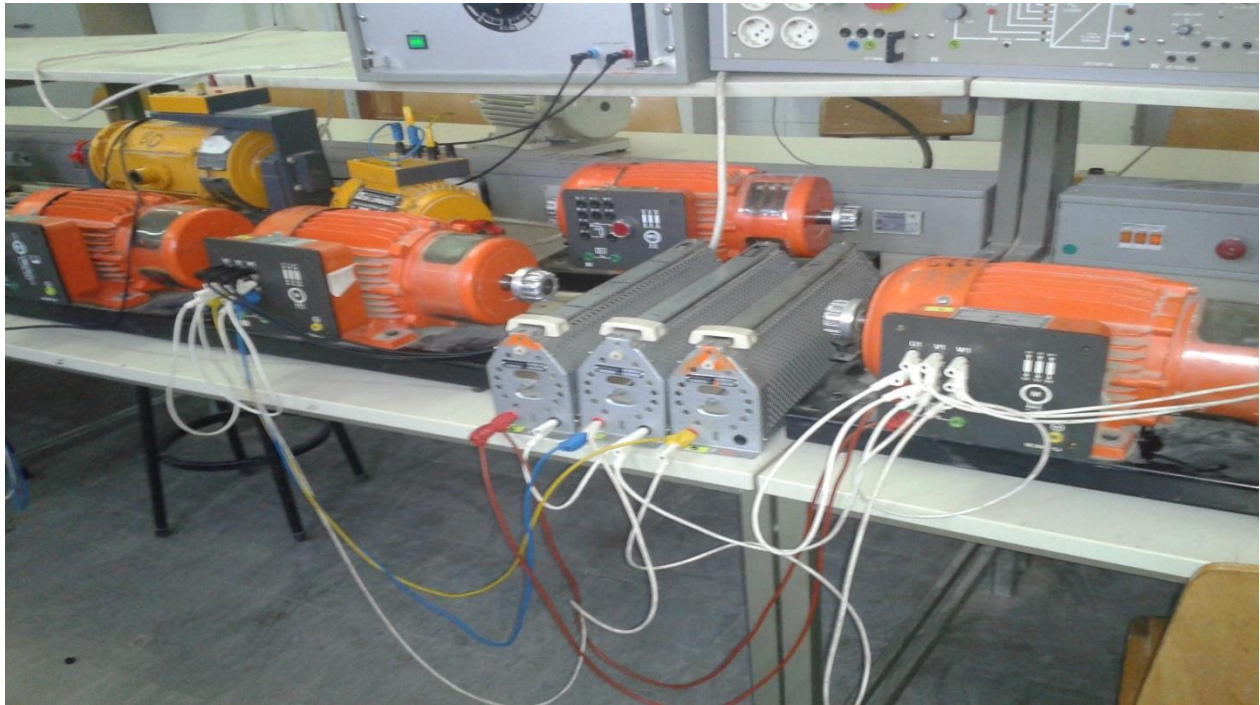
Photo (3) : Montage de l'arbre électrique par insertion des résistances au niveau de la ligne de transmission.
