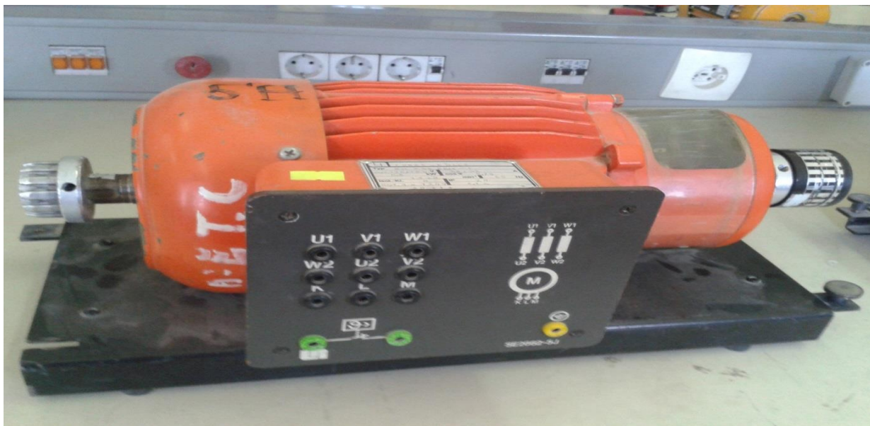
Figure(IV.17) : Photo de la machine asynchrone à rotor bobiné doublement alimentée (P=0.8KW).
