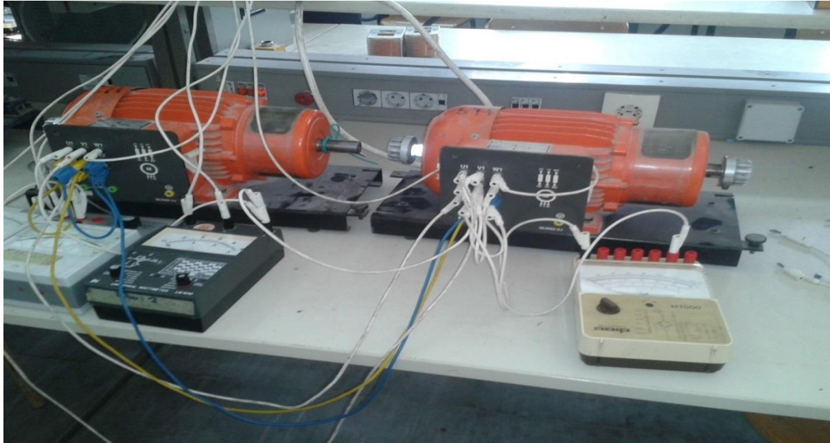
Figure(IV.20) : Photo de montage arbre électrique.
