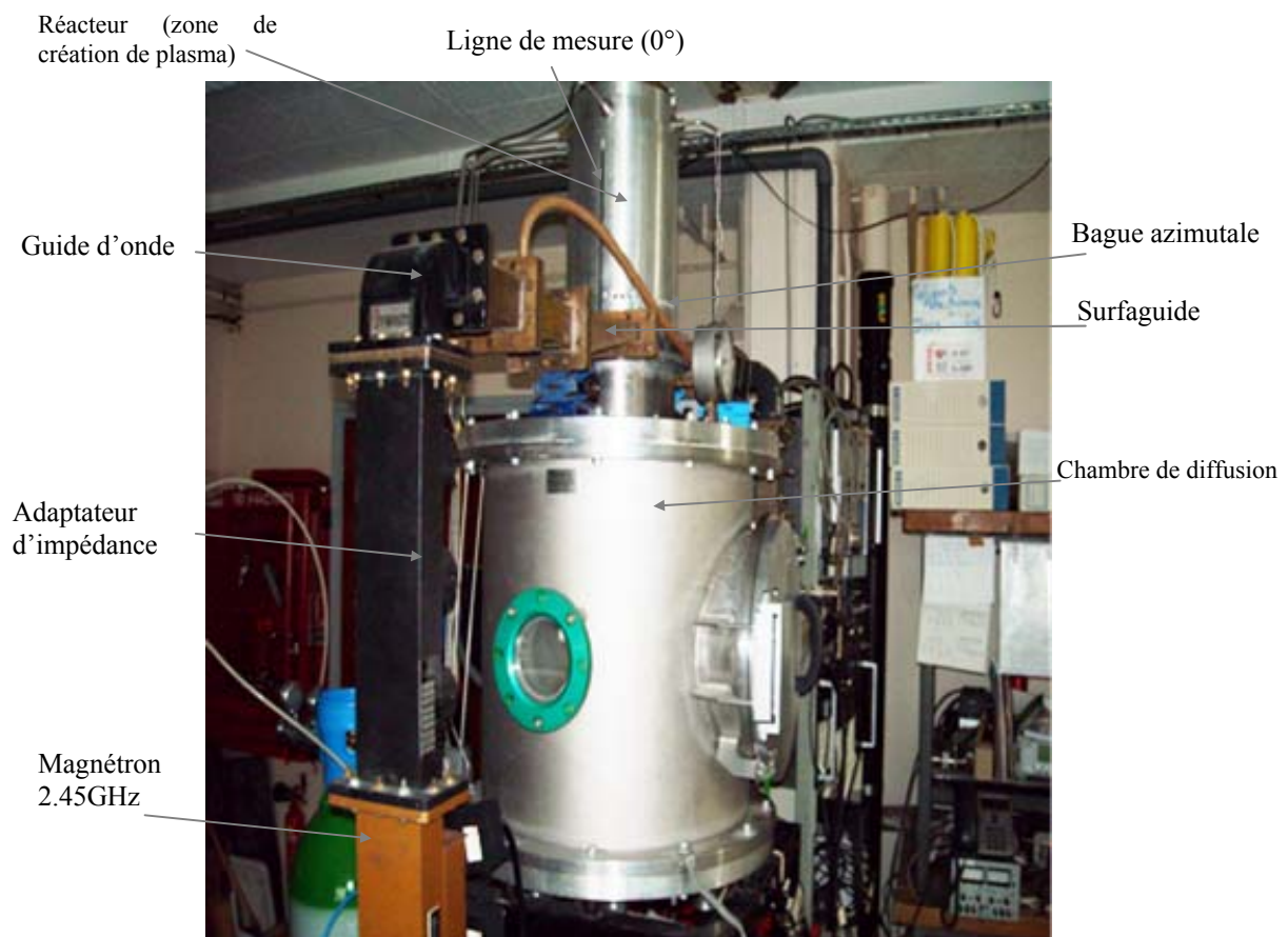
Figure IV.2 : Photo du réacteur PECVD conçu au laboratoire (LPGP)
