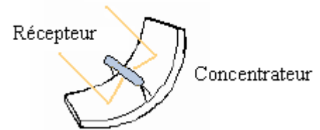
Fig 1.10: Schéma de principe d'un concentrateur cylindro-parabolique [4].
