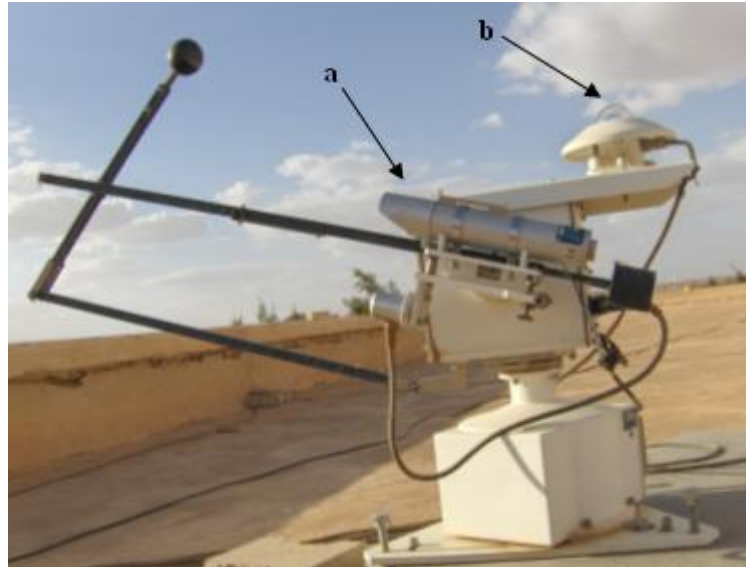
Fig 1.2: Instruments de mesure du rayonnement solaire [22].
