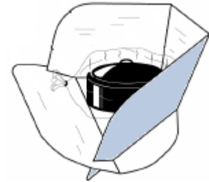
Fig 1.12: Schéma de principe d'un cuiseur à panneaux [33].
