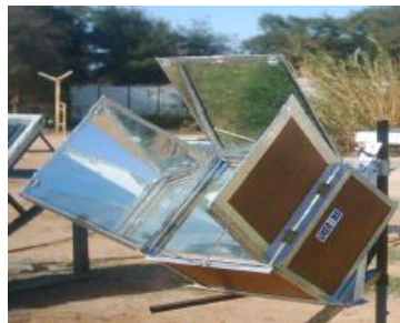
Fig 1.28: Cuisson solaire boîte réalisée et testée à l'URER/MS par Harmim et al. [60].
