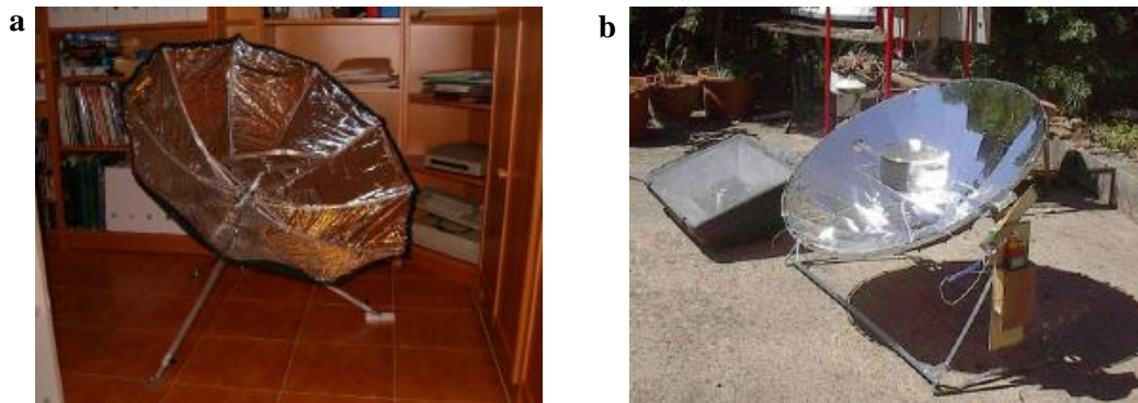
Fig 1.32: (a) Cuiseur parapluie réalisé par José M. Arenas [71], (b) cuiseur parabolique réalisé par Grupp et al. [72].
