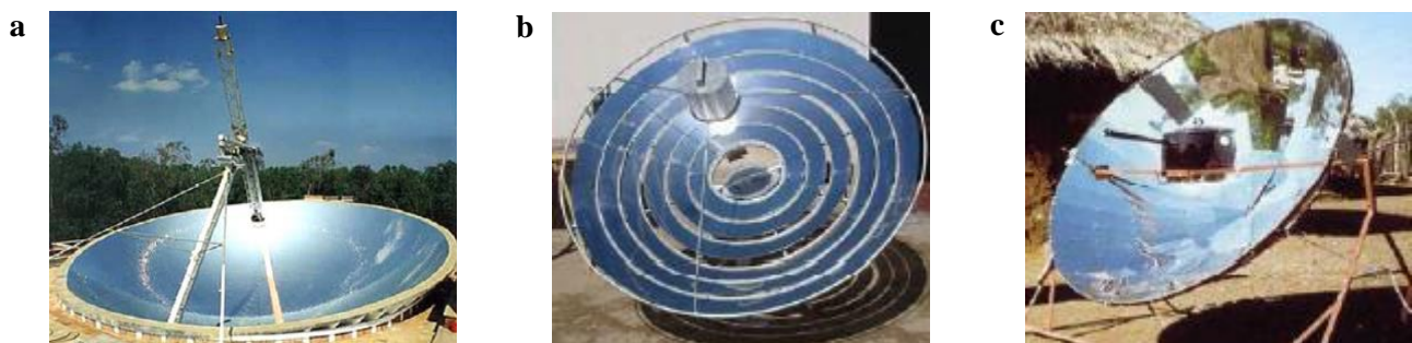
Fig 1.19: Cuisseurs solaires concentrant la lumière par-dessous: (a) cuisseur sphérique; (b) cuisseur à miroirs de Fresnel; (c) cuisseur parabolique.
