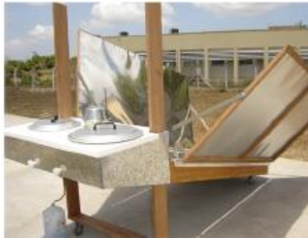
Fig 1.20: Cuiseur solaire indirect avec capteurs plans vitrés.
