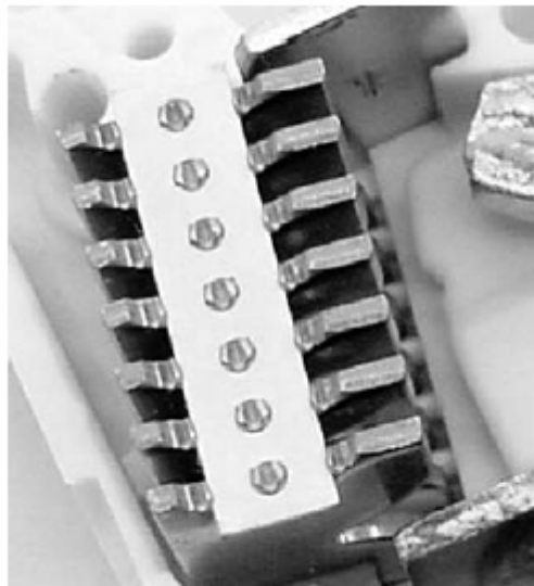
Figure I.6 : Chambre de coupure d'un disjoncteur MCCB
