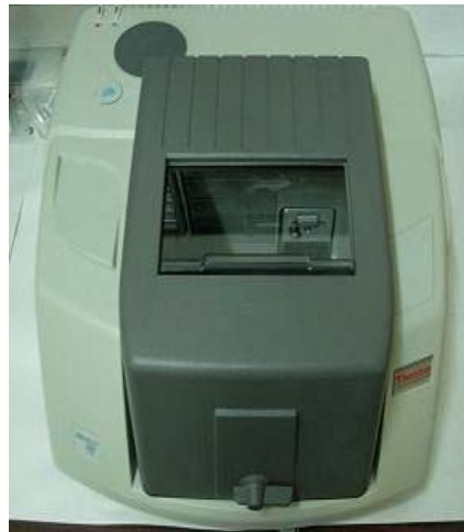
Fig. II.11 : Photo d'un spectromètre infrarouge de type Thermo Nicolet Avatar 360.
