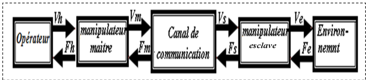
Figure I-1 : Schéma générale d'un télémanipulateur.
