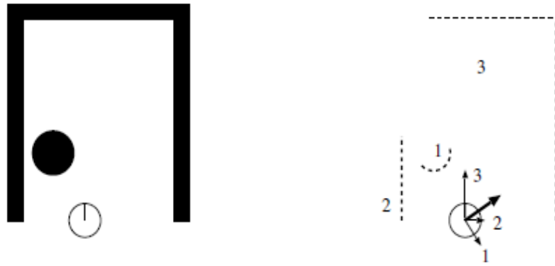
Figure 4.3 : Illustration de la combinaison de différents potentiels primitifs dans l'espace relatif au robot
