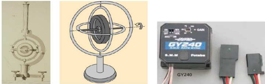
Figure 1.6 : Gyroscope mécanique de Foucault et gyromètre Futaba à structure vibrante
