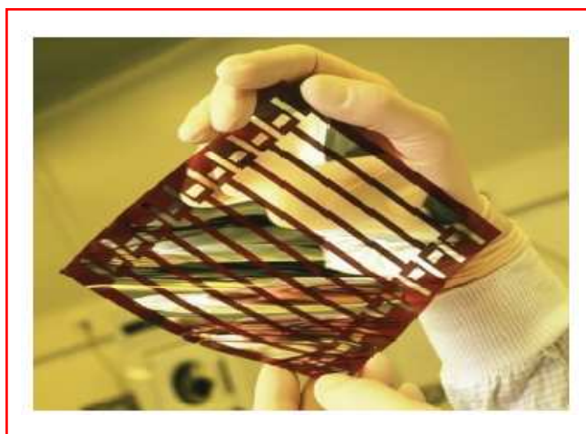
Figure I-15 Cellule solaire tout organique sur substrat souple
