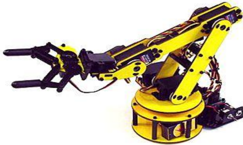
Figure (II.2) : Bras Manipulateur (Réal) SRX10 (4 axes + pince de préhension)
