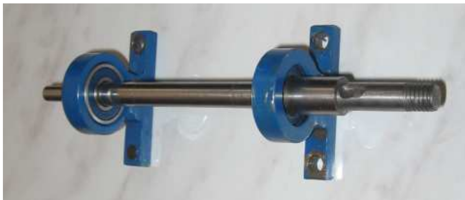
Figure N *3.9 : L'axe avec des chemises et des roulements
