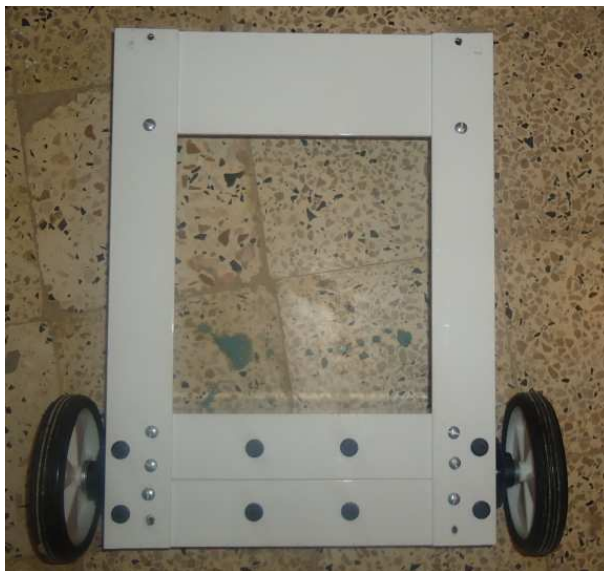
Figure N •E.1 : Base mécanique du robot
