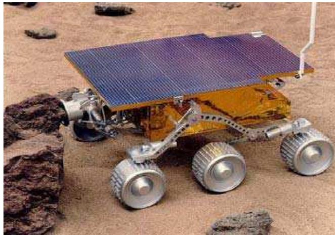
**Figure I.1** : Le robot mobile « Séjourner » utilisé pour la mission pathfinder de la NASA
