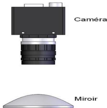
Figure (1.16) : Exemple de capteur catadioptrique.
