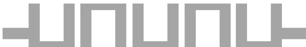
Figure 2.19 Filtre à résonateurs en U couplés.
