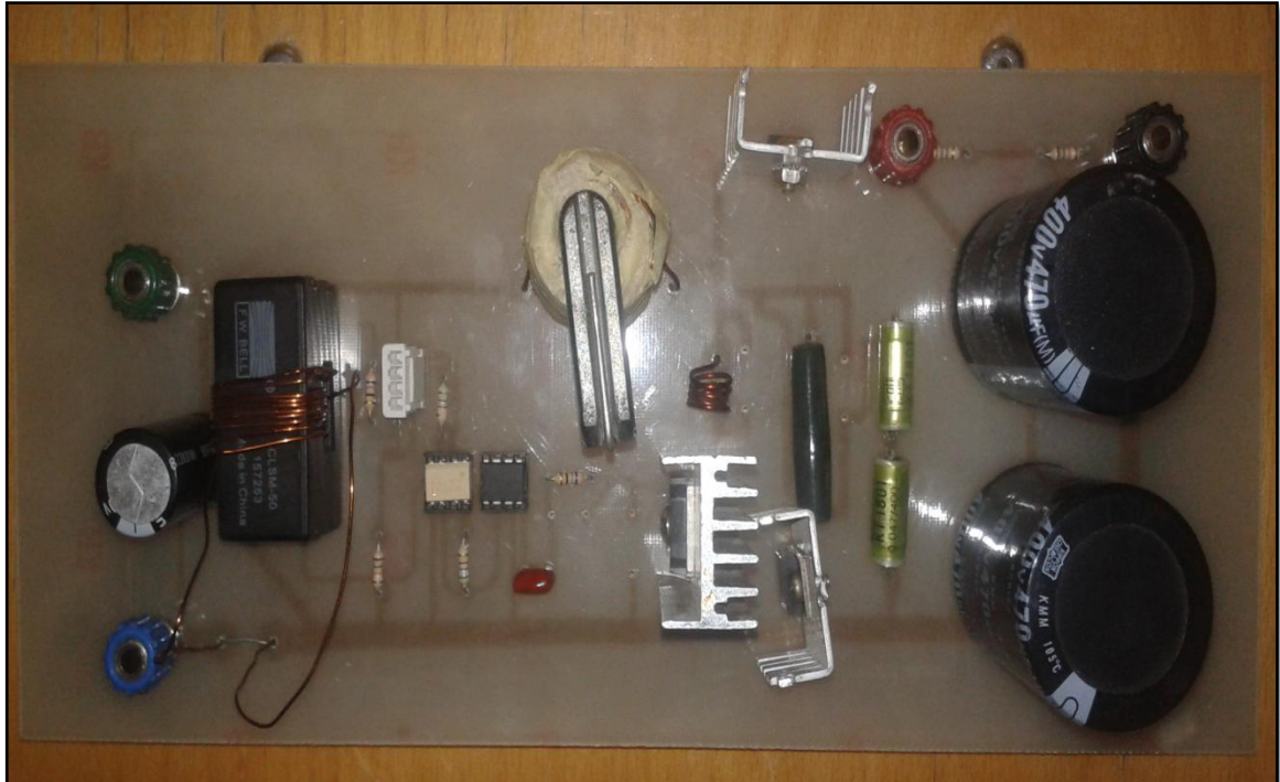
Figure (IV-11) : schéma du circuit du hacheur BOOST réalisé
