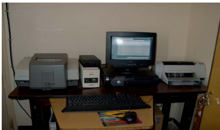
Figure 1.22 : Spectromètre à transformée de Fourier de type Nicolet (Avatar 360 N) utilisé pour la caractérisation FTIR.
