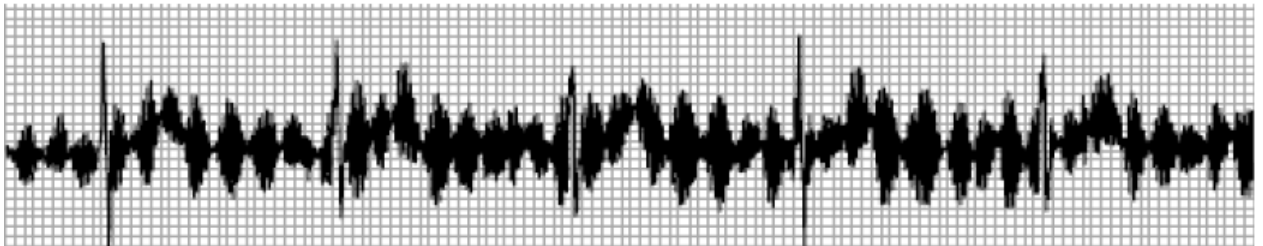
Fig.2.10 Interférences électriques du secteur.
