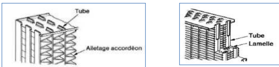
Figure III.6 : faisceau d'un Radiateur
