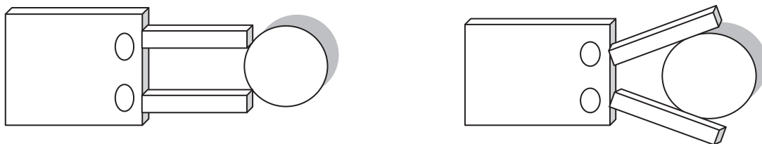
Figure III.27. Différence entre les pinces parallèle et angulaire
