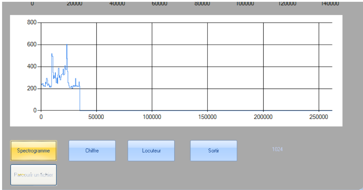
Figure V. 6 interface démonstratif de la phase prétraitement (graphe représentatif de la FFT du mot سبعة ).
