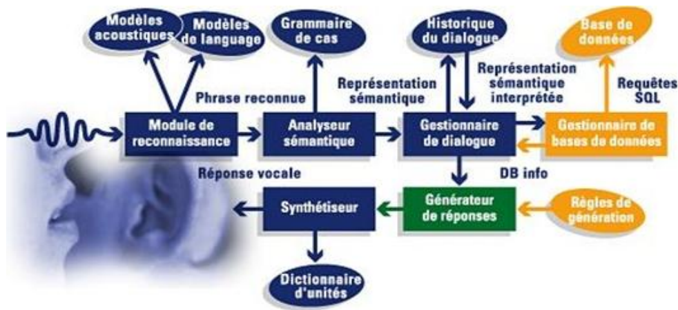
Figure IV. 2 Architecture fonctionnelle d'un système de dialogue homme-machine couplé à une base de données (source Vecsys)
