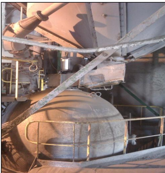
Figure2.7 : Photo réelle de la pompe flux. [21] Figure2.8 : Description de la pompe à flux. [21]
