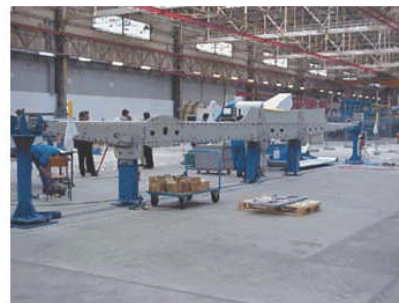
Poutre ventrale composite sur avion Airbus A340-500/600. Pièce de 16 m de long en composite monolithique fibres de carbone dans une résine époxyde
