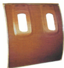
Pièce aménagement intérieur d'avion en composite tissu de fibres de verre dans une résine phénolique
