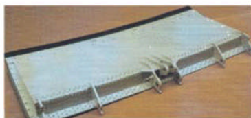
Partie mobile de voiture Airbus A320 en composite sandwich âme nid d'abeille papier en fibres d'aramide/résine phénolique et peaux en tissu en fibres de carbone/résine époxyde
