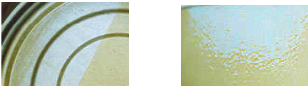
Figures 1.10 : Manque de revêtement [2] .
