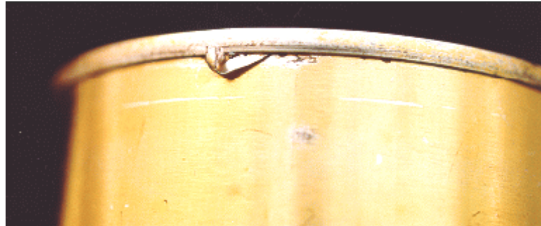
Figure 1.20 : Bord à sertir déchiré (B.S.D.) [2].
