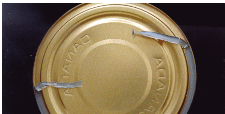
Figure 1.32 : Jointage élastique défectueux [2] .
