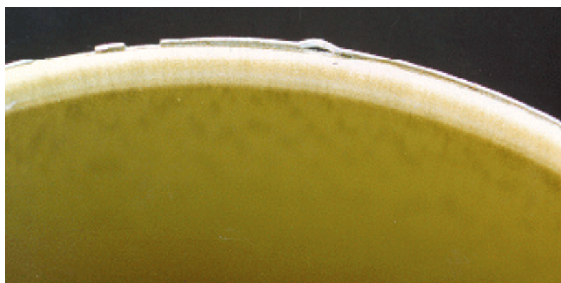
Figure 1.17 : Bavures sur le bord à sertir [2]
