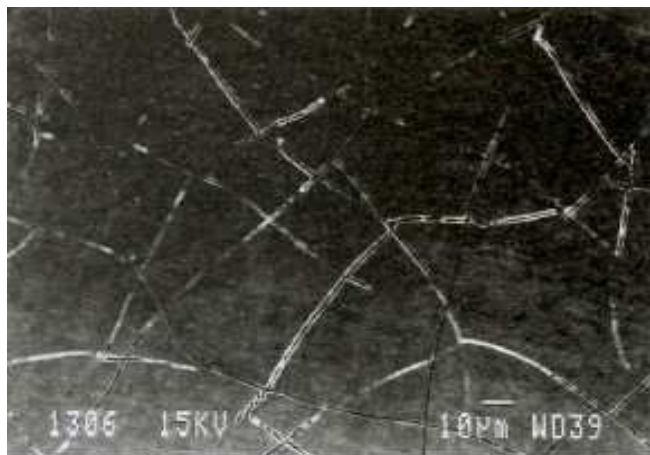
Fig.V.13b : Aspect d'un dépôt de chrome dur dans les mêmes conditions que (V.13a) mais à plus fort grossissement.
